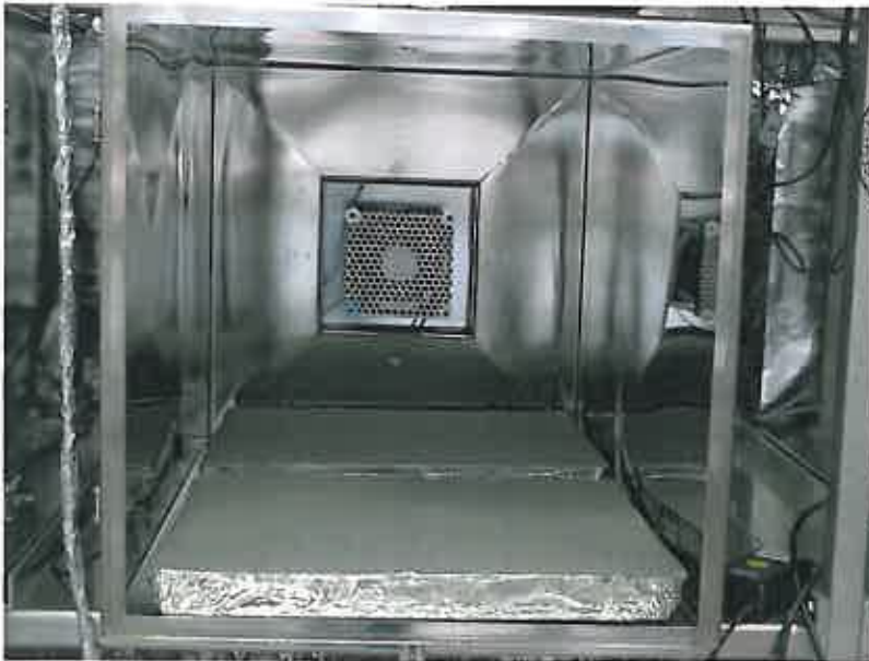
Bild 3: Prüfkörper in der 200 L-Emissionsprüfkammer
