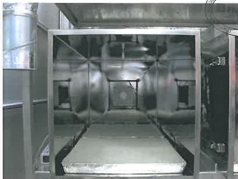
Bild 3: Prüfkörper in der 200 L-Emissionsprüfkammer
