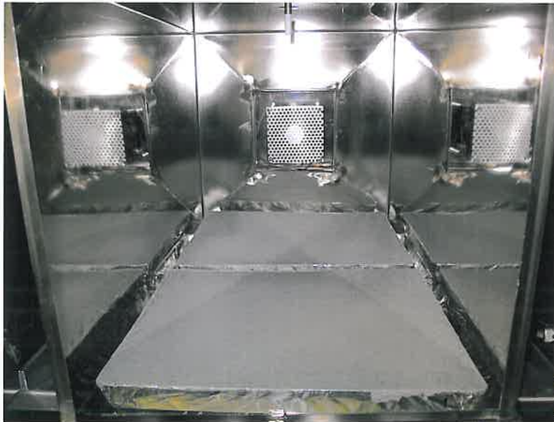
Bild 3: Prüfstücke in der 200 L-Emissionsprüfkammer.
